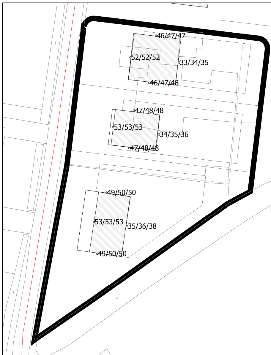
Figuur 3: Geluidsbelasting t.g.v. de Kruisbeekweg op de nieuwe woningen incl. aftrek ex. art. 110g Wgh
