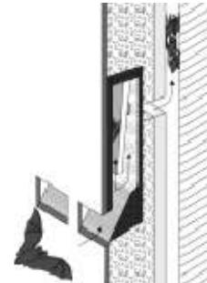
Figuur 12. Vleermuiskast type 2FR in verbinding met spouwruimte, open stootvoegen zijn hierdoor geen noodzaak.
