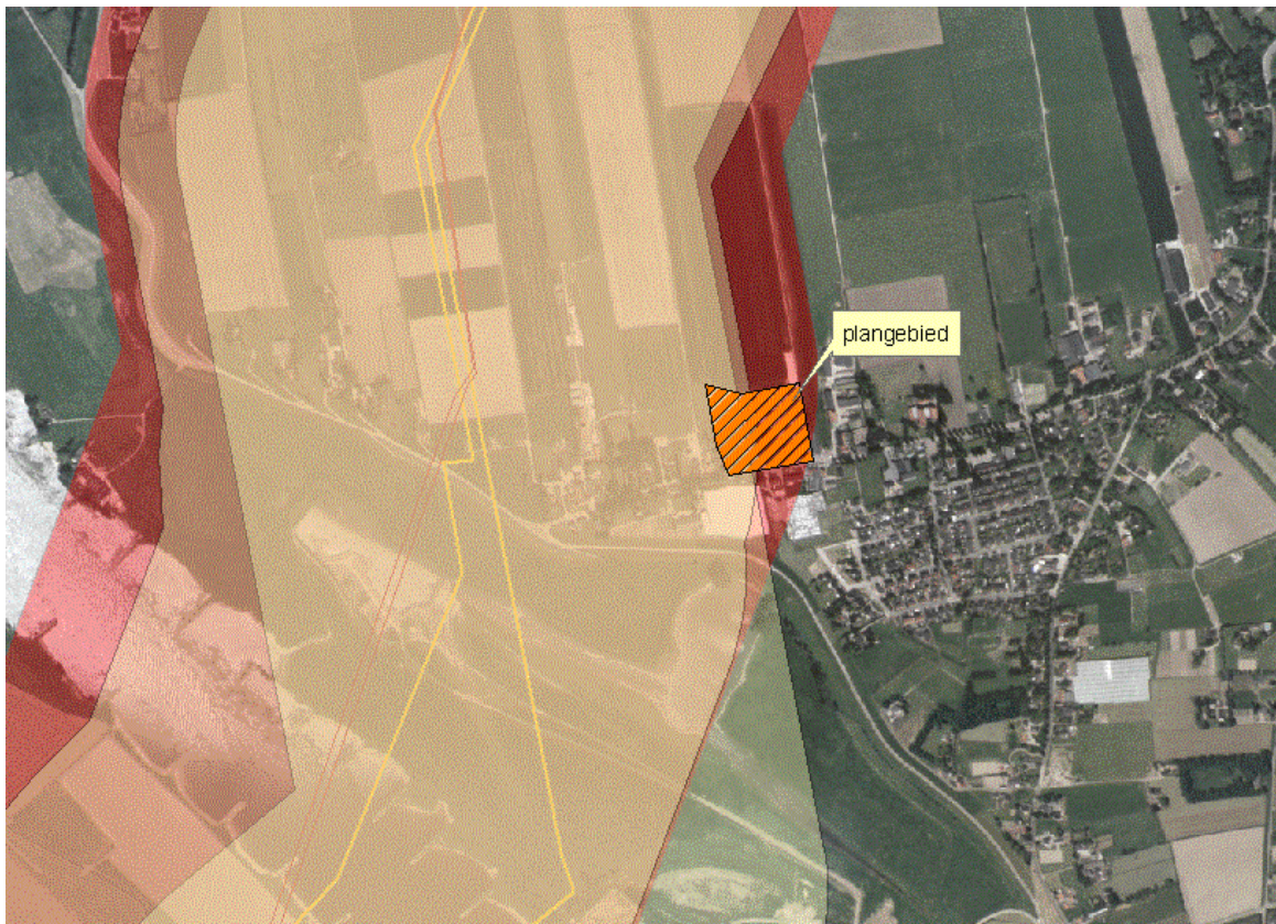
Figuur 2: 1%-letaal contouren gasleidingen
