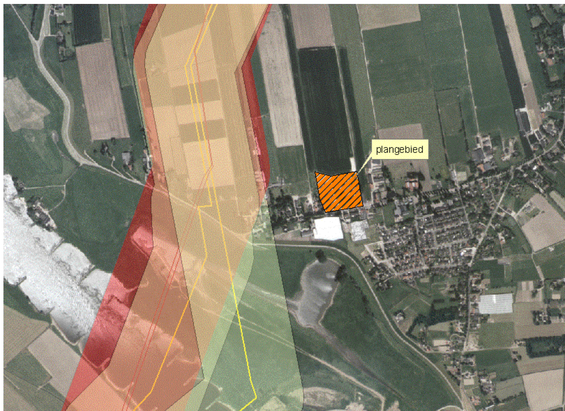
Figuur 1: 100%-letaal contouren gasleidingen
