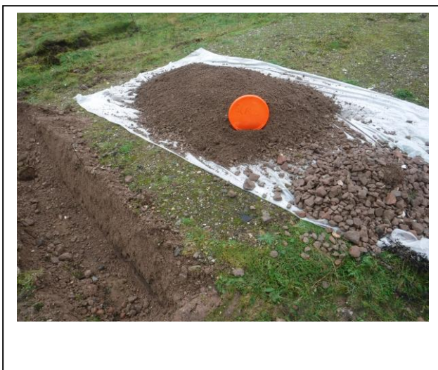
Foto: Inspectiegat SL-B02 (puingranulaat)
