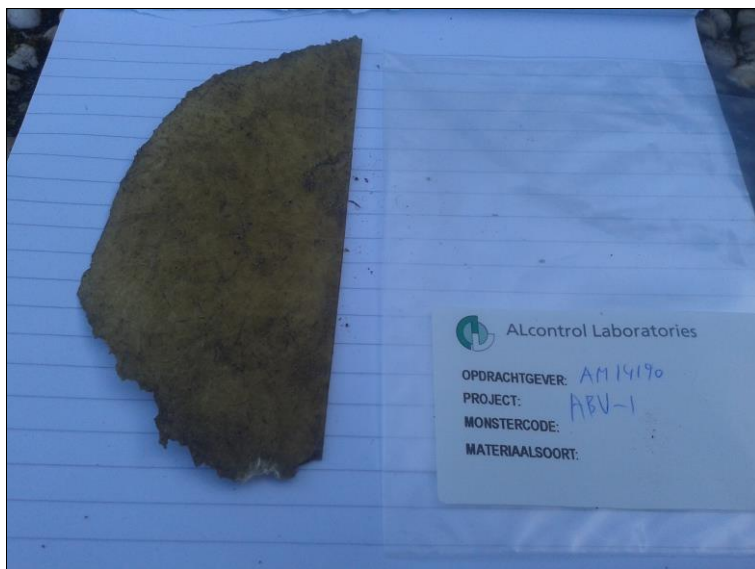
Afbeelding 4: asbestverdacht materiaal nabij inspectiegat ABGC7
