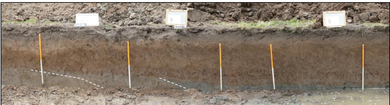
Figuur 7: Zicht op zuidelijke helft van profiel 1.1 (circa 2-10 m), de noordelijke helft staat reeds onder water. De grijze vullingslagen van de geul zijn zichtbaar (witte stippellijnen).
