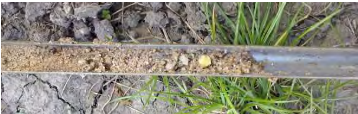
Figuur 16: Foto van het grind dat onderin de boringen is aangetroffen..
