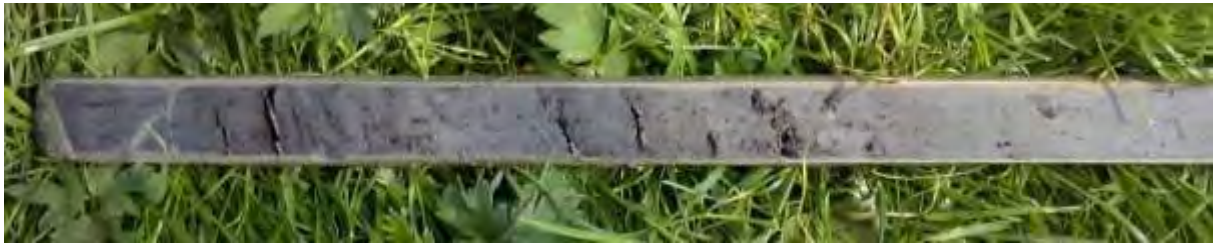
Figuur 16: Foto van de venige klei die onderin de boringen is aangetroffen.
