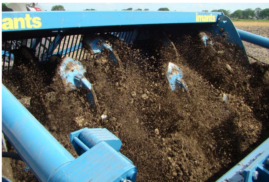
Afb. 7 Foto spitmachine gebruikt bij grondverbetering
