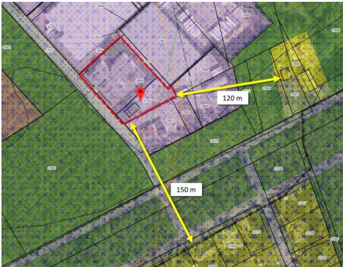
afbeelding 7: afstand tot dichtstbijzijnde woning rond het nieuwe transformatorstation
