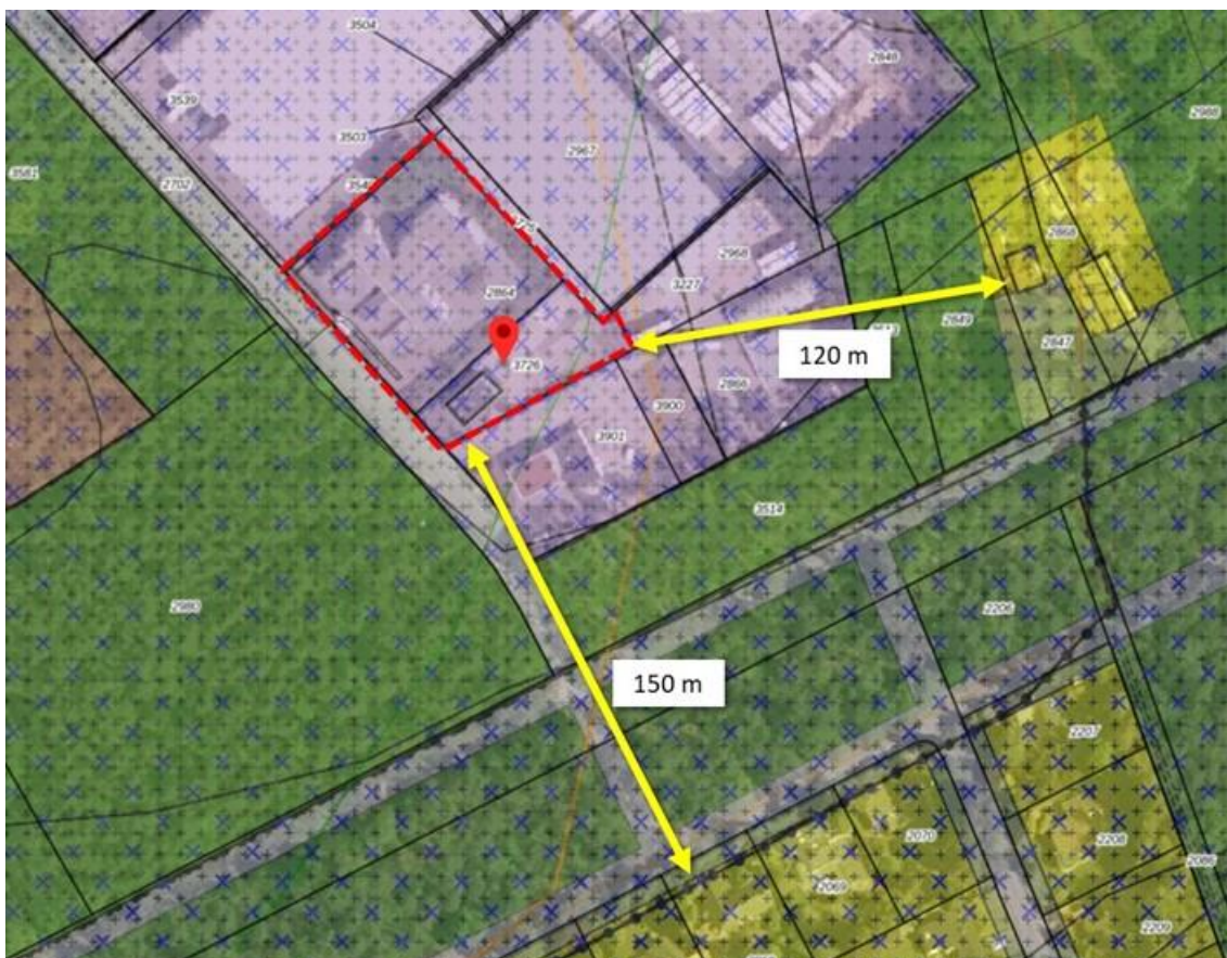
afbeelding 3: afstand tot dichtstbijzijnde woning rond het nieuwe transformatorstation
