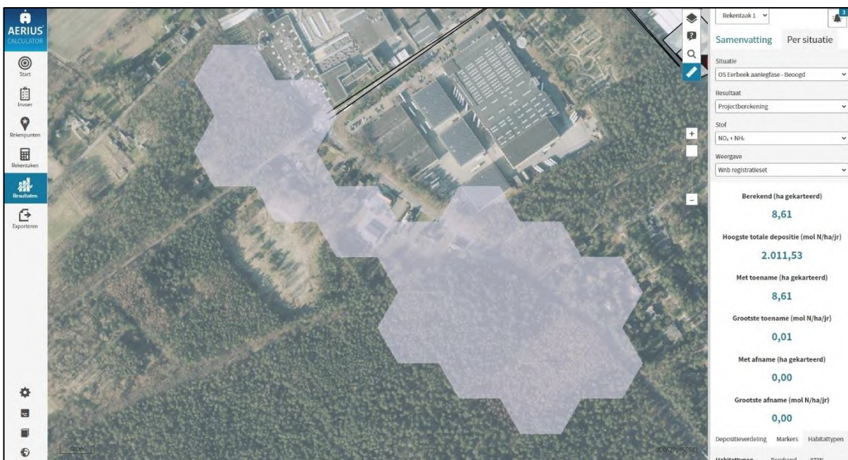
Figuur 1. Berekening van het aantal hexagonalen waarop depositie is berekend. Rechtsboven in beeld is de locatie te zien waar het transformatorstation wordt uitgebreid.
