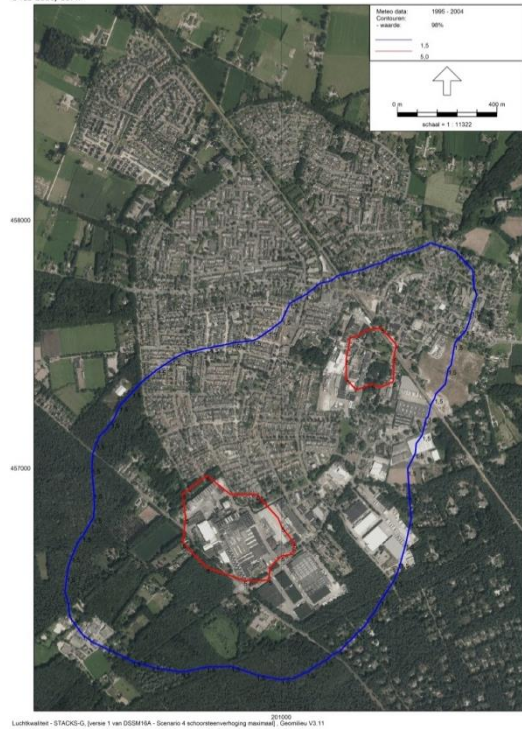
Figuur f: Contouren van 5 en 1,5 ou E /m 3 als 98-percentielwaarde in de vergunde situatie met maximale schoorsteenverhoging (scenario 3)
