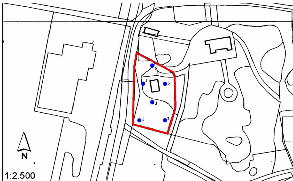
Afbeelding 8. Boorpuntenkaart IVO door middel van grondboringen Bouwlocatie Stationsweg, Brummen. De boorpunten zijn in blauw weergegeven. Het plangebied is rood omkaderd. Schaal 1: 2500.
