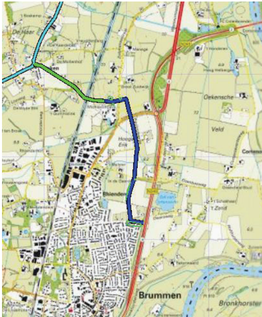
Figuur 5.5 Kilometer leiding behorende bij de maximale overschrijding van de FN-curve voor N-559-21 van N.V. Nederlandse Gasunie (groen)
