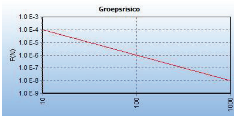
Figuur 5.3 FN curve N559-21 van N.V. Nederlandse Gasunie voor de kilometer tussen stationing 0.00 en stationing 1000.00
