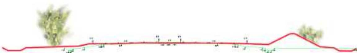
afb. 27: nieuw dwarsprofiel hmp. 149.600 (tussen de Koningstraat en de van Heemstraweg)
