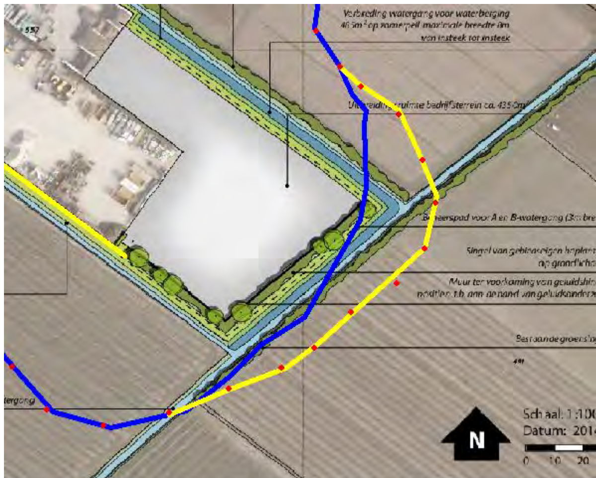
Afbeelding 7 In geel: 70 dB(A)-geluidcontour (hoogte 1,5 meter) inclusief uitbreiding.
