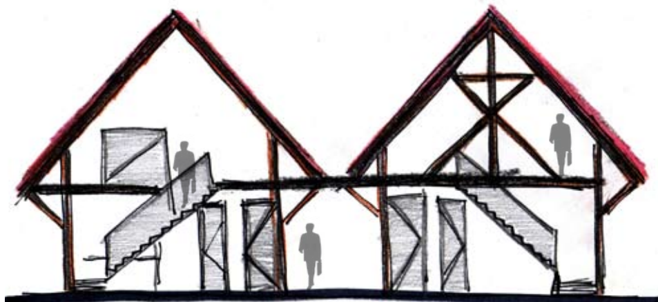
schetsontwerp vormelingenloods, dwarsdoorsnede
