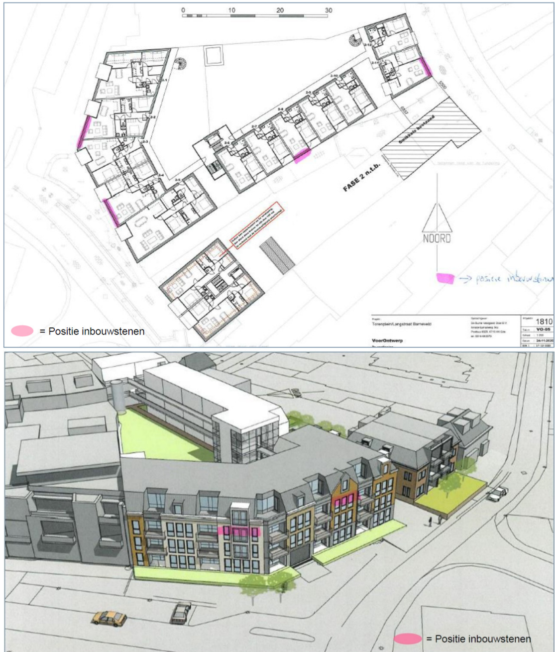
Figuur 3. Locatie en positie permanente voorzieningen gewone dwergvleermuis in de nieuwbouw.
