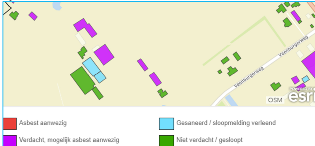
Figuur 7: asbestdakenkaart Provincie Gelderland
