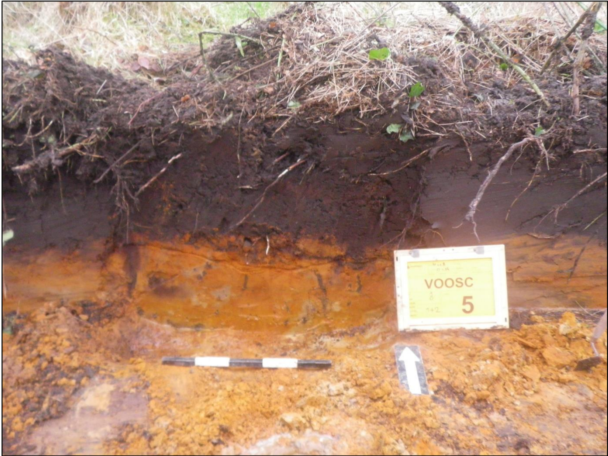
Afbeelding 5: profiel 2 in put 1. Hier is de ijzerrijke C-horizont duidelijk zichtbaar.
