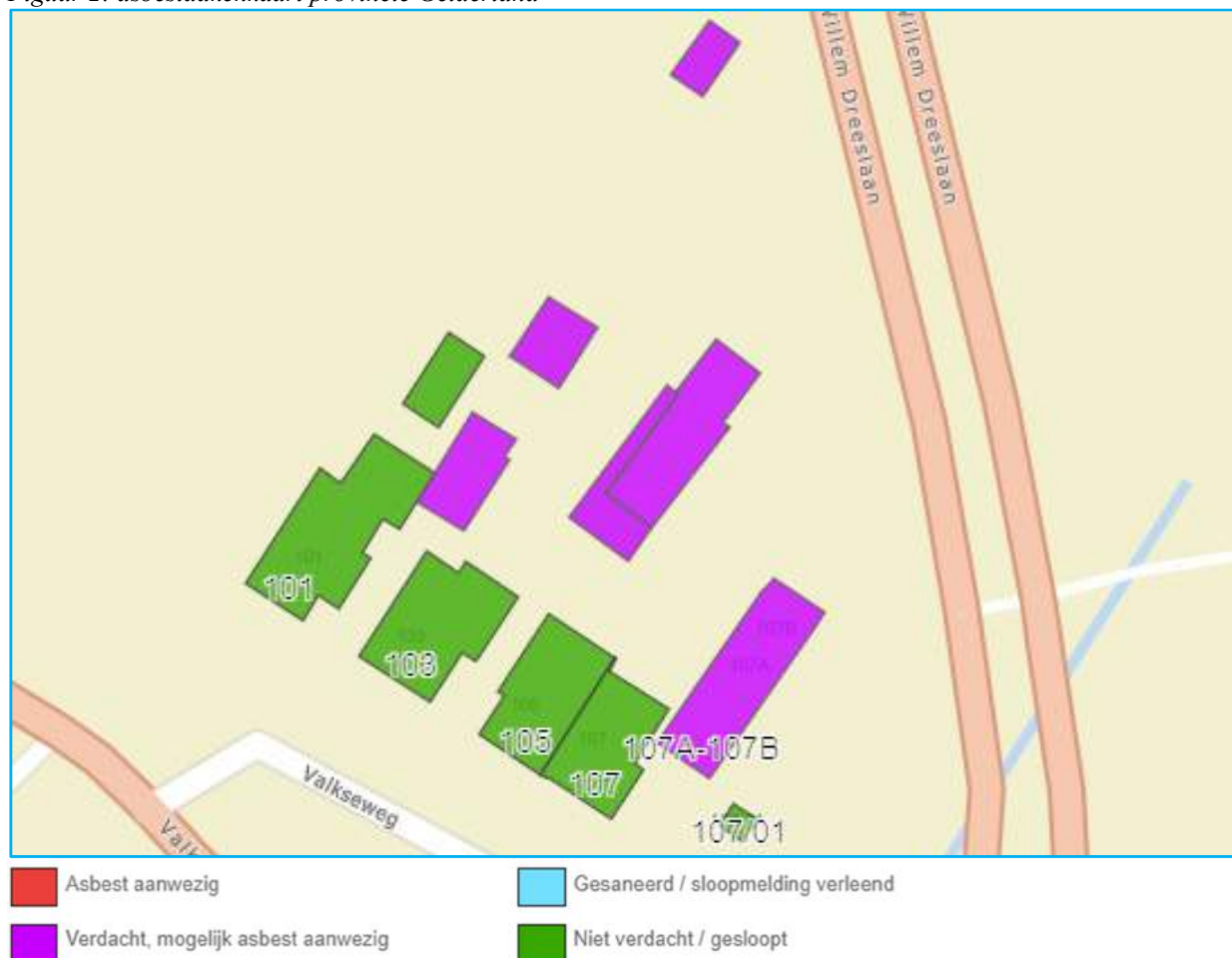
Figuur 2: asbestdakenkaart provincie Gelderland
