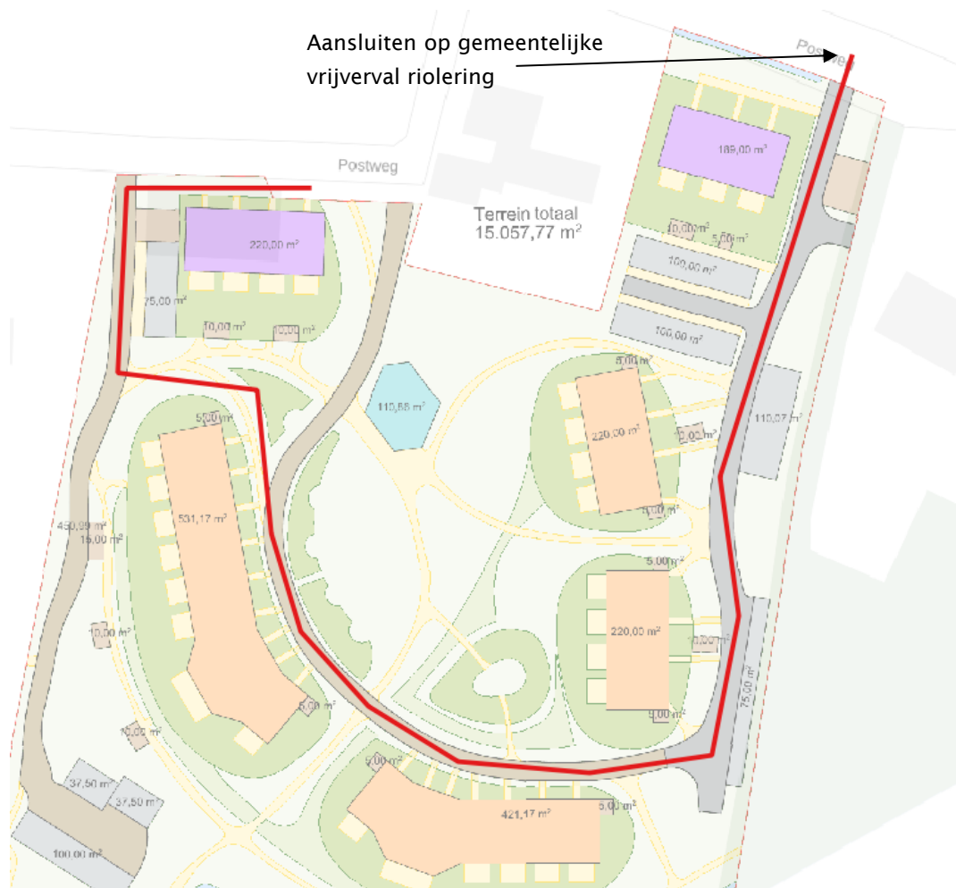
Figuur 6: Maatgevende streng voor aansluiting op gemeentelijke vrijvervalriolering
