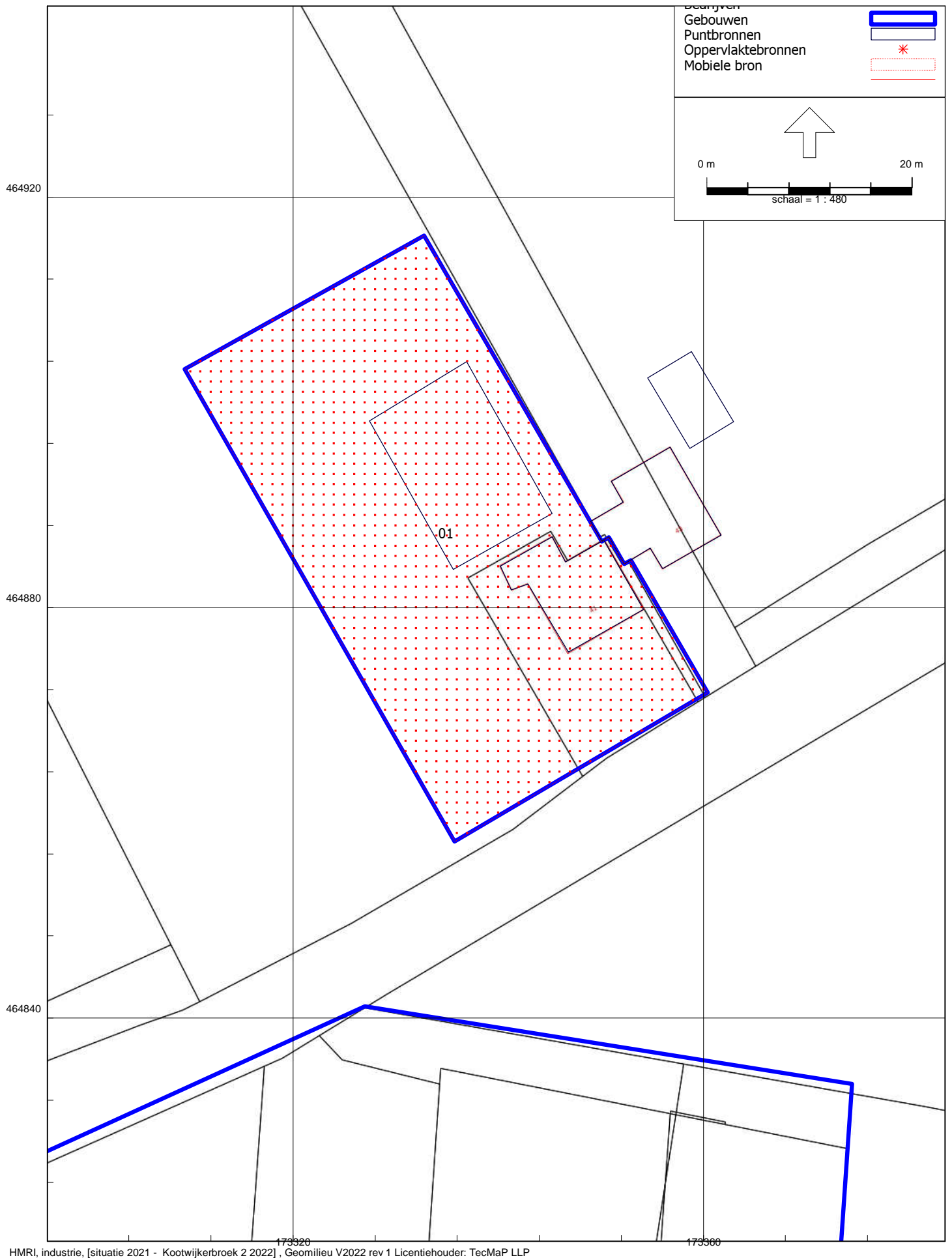
figuur 5a: Overzicht rekenmodel met ligging geluidbronnen -directe hinder- volgens maximale invulling
