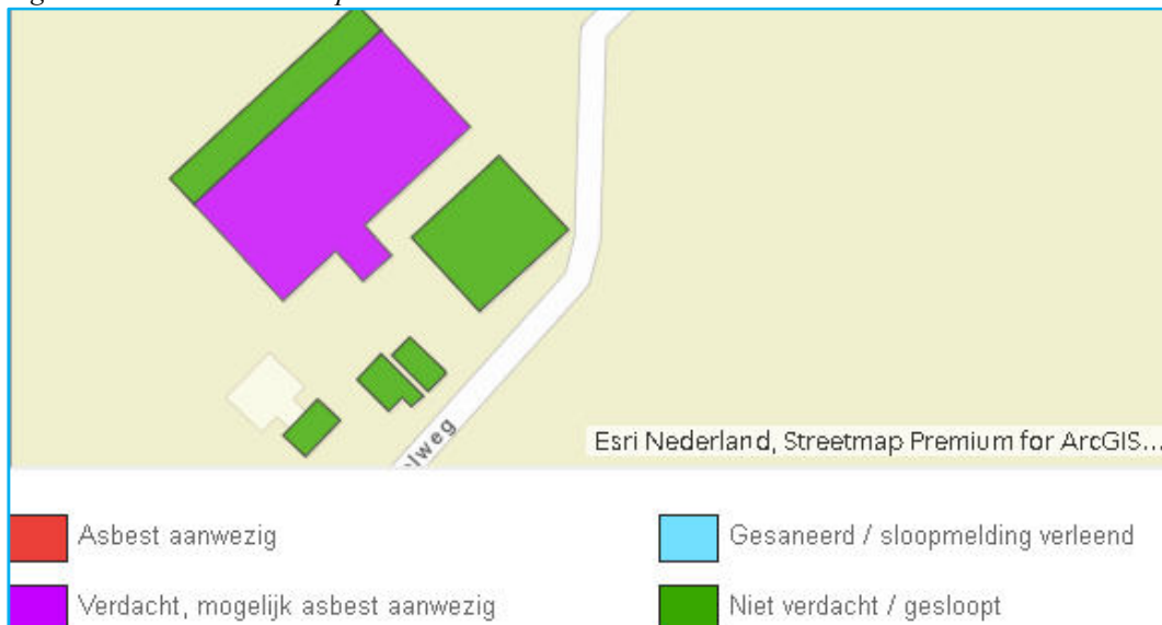
Figuur 2: asbestdakenkaart provincie Gelderland
