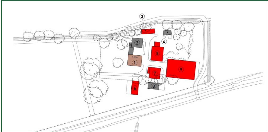
Afb. 1.3: Tekening met overzicht van de te slopen gebouwen. De te slopen gebouwen (3, 5, 6, 7 en 9) zijn met rood aangeduid. Bron: Struikhoeve Advies B.V./Landborg.
