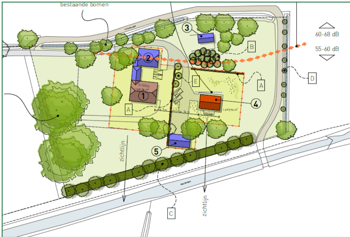
Afb. 4.3: Landschappelijke inpassing planvoornemen. Er wordt op meerdere plekken inheems groen aangeplant, waaronder een houtwal met onderbeplanting parallel aan de Esvelder Beek. Het plan vormt hiermee een versterking van de GO ter plaatse. Bron ondergrond: Struikhoeve Advies B.V./Landborg.
