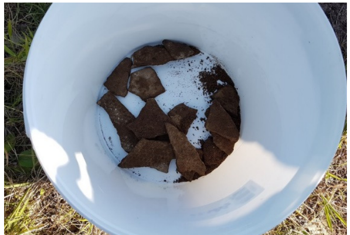
Foto 4: asbestverdacht materiaal SL101
