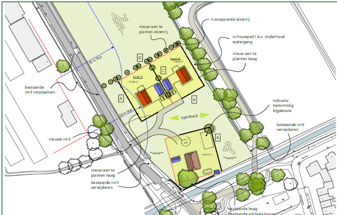
Afb. 1.3: Tekening met voorstel van nieuwe situatie. Over het terrein zullen nieuwe landschapselementen gerealiseerd worden. Er zullen twee nieuwe percelen worden gerealiseerd met een woning en bijgebouw. Bron ondergrond: Struikhoeve Advies B.V./Landborg, projectnummer 3539.
