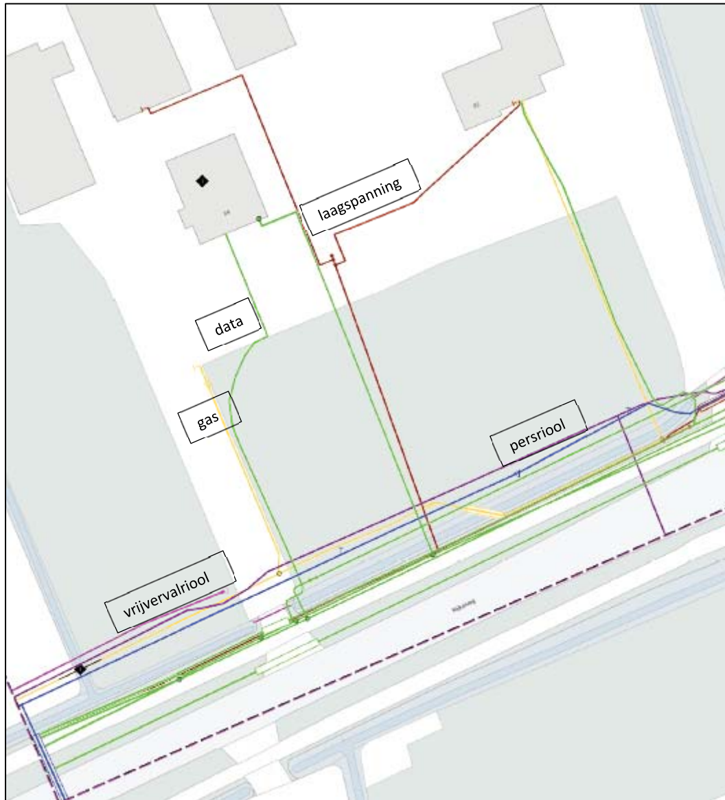
Afbeelding 7: Ligging kabels en leidingen klicmelding
