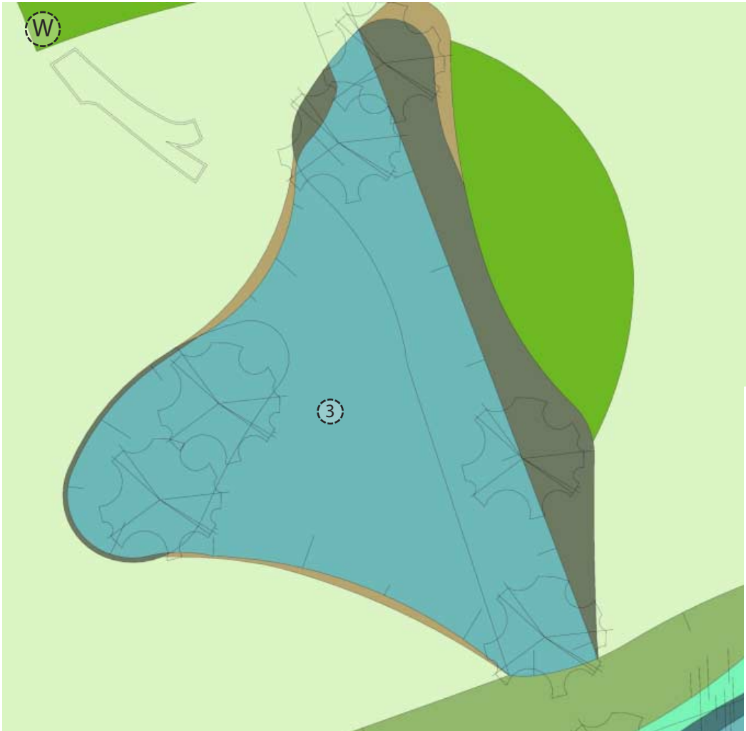
Afbeelding: idem, volledig gevuld met hemelwater (3): diepte van 0,65 m en daarmee 183 m3 afstromend regenwater bergend.
