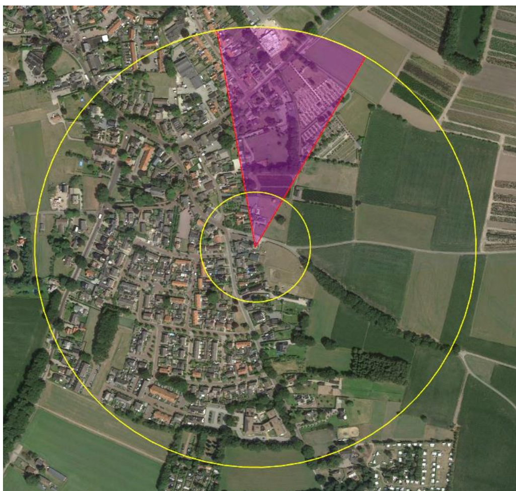
Afbeelding 1: Luchtfoto van het gebied rondom molen De Hoop. De luchtfoto is zuiver noord georiënteerd. De grote gele cirkel geeft de straal van 400 meter rondom de molen aan; de kleine gele cirkel een straal van 100 meter. De rode, radiale lijnen zijn de uiterste raaklijnen van het rekengebied (paarse vlak). De radiale lijnen zijn 350° en 30° met de molen als middelpunt. (Bron: Google Earth).
