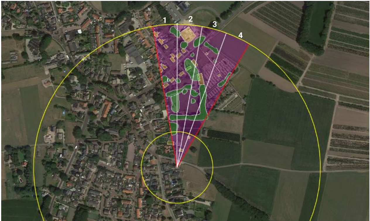
Afbeelding 4: Het rekengebied met alle belemmerede objecten in de huidige situatie. De groene vlakken zijn bomen en de gele vlakken zijn gebouwen. De luchtfoto is zuiver noord georiënteerd. De twee rode lijnen zijn 350° en 30°. De witte lijnen, met de klok mee, zijn 0° (360°), 10°, en 20°. De lijnen verdelen het rekengebied in 4 sectoren van 10°. De nummering van de sectoren telt op met de klok mee.
