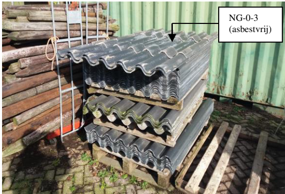
Foto 7: Asbestvrije golfplaat losstaand nabij schuur 2. (NT-code waargenomen)
