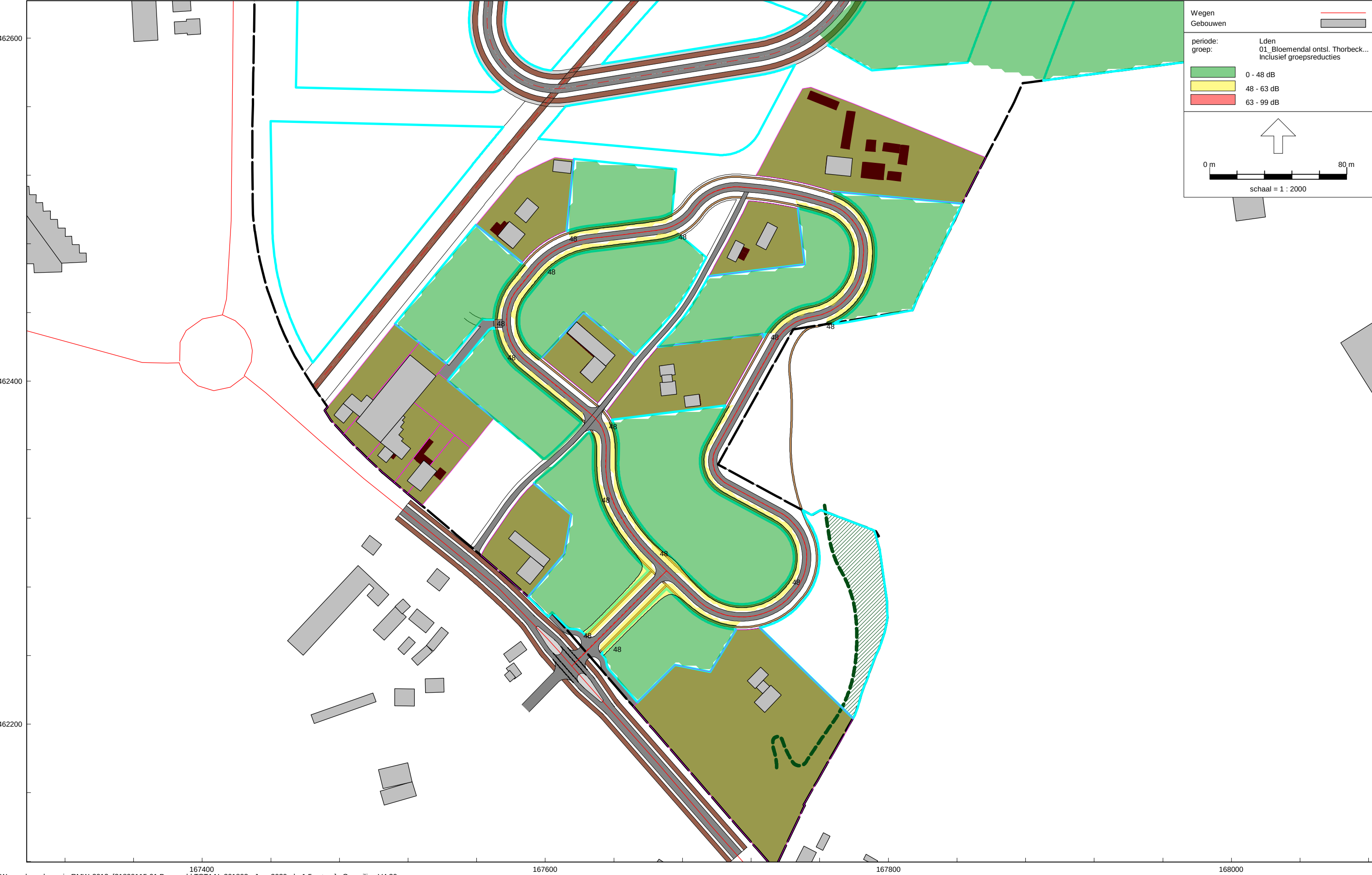
Vlekkenplan Bloemendal in Barneveld Geluidcontouren tgv ontsluitingsweg Thorbeckelaan, na aftrek 5 dB ex. art. 110g Wgh - h=1,5m+mv
