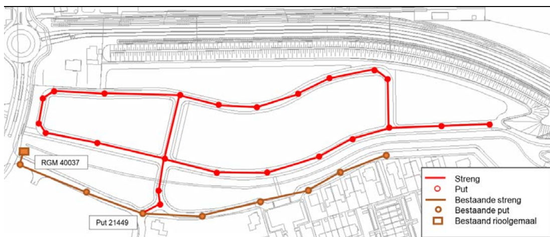
Figuur 5.3 Schematische weergave structuur d.w.a.-stelsel
