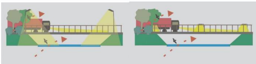
Figuur 30: Links: Zoals het niet moet, De verlichting schijnt op wateren en bomen die als vliegroute gebruikt kunnen worden en zo ongeschikt worden. Rechts: Zoals het wel moet! Door verlichting alleen op een brug te laten schijnen en niet op wateren en bomen kan het waterelement en de bomen als vliegroute gebruikt worden (Bron: vleermuizenindestad.nl.)
