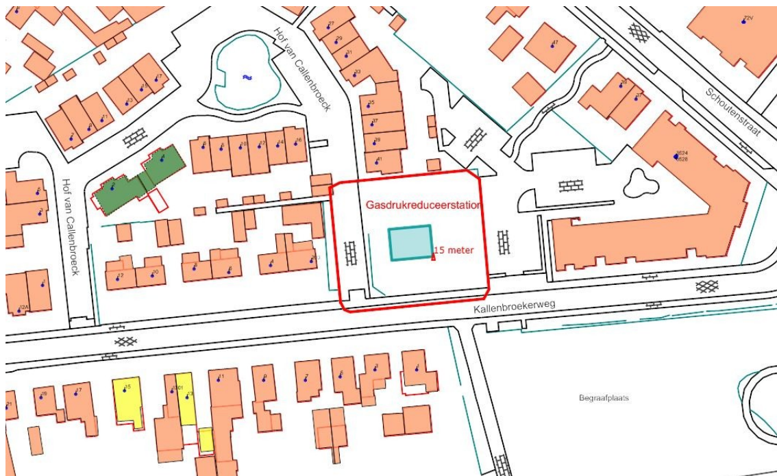
Figuur 3: Gasreducerstation met de plaatsgebonden risicocontour van 10^{-6}
