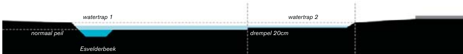
'getrapte overloop' (Actualisatie WSP, gem. Barneveld): watertrap 1: 0.20m peilstijging, watertrap 2: 0.40m peilstijging
