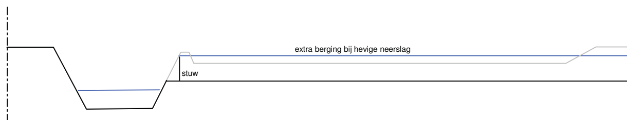
afbeelding 4.7. Schematische doorsnede stuw in blauwe vinger
