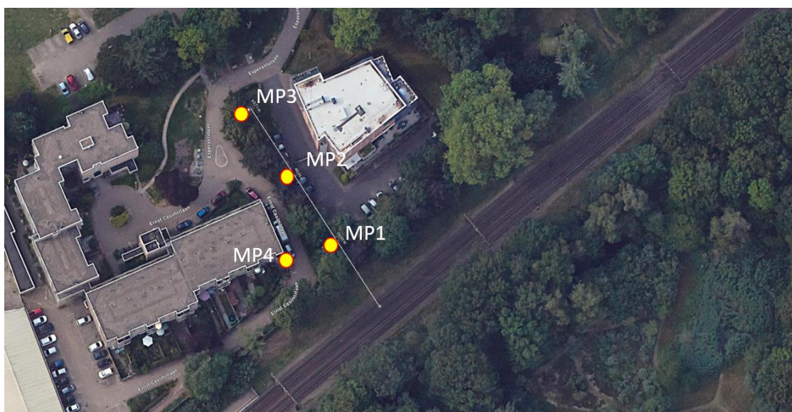
figuur 3: meetposities, MP1 t/m MP3 in de bodem en MP4 op de fundatie
