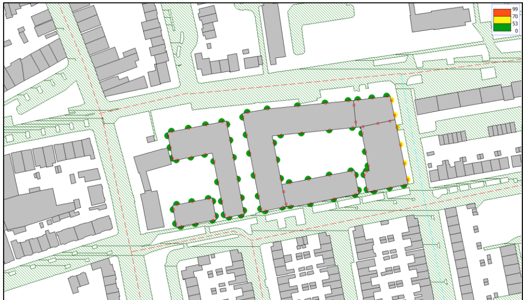
Hoogst berekende geluidbelasting vanwege de Fagelstraat
