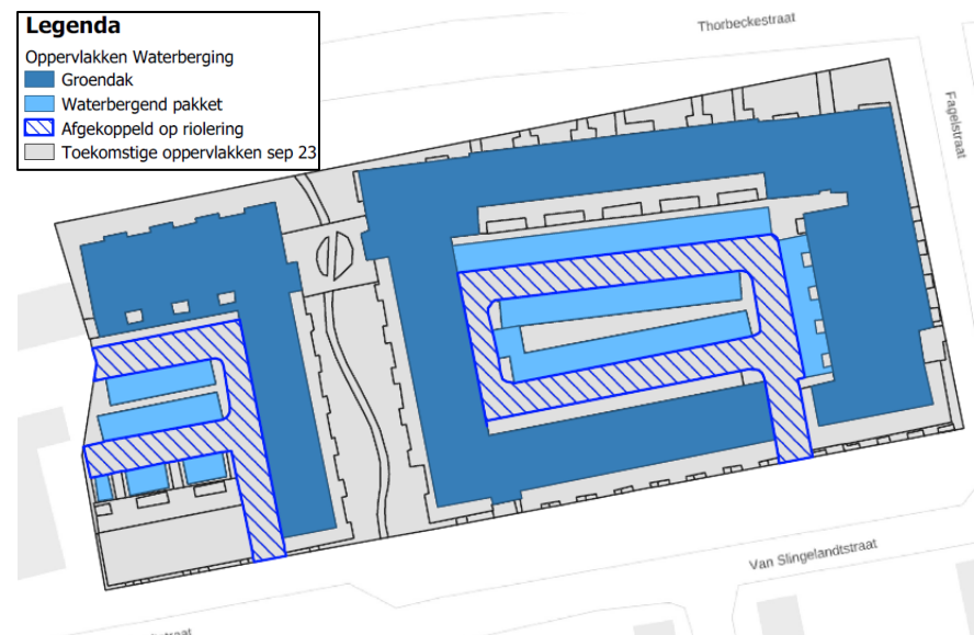
Figuur 4-1 Overzicht waterbergende voorzieningen
