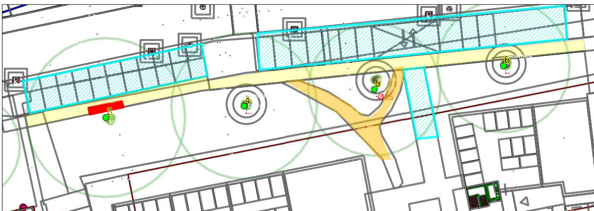
Afbeelding 45: Randvoorwaarden: - Rood: graafvrije zone boom 3 (2 m uit hart stamvoet) - Geel: onder nieuwe trottoir bomenzand, maximale ontgraving 15 cm - Oranje: voetpad met halfverharding - Blauw: parkeerplaatsen/ontsluitingsweg met Permavoid boomkragen (max. ontgraving 20 cm)
