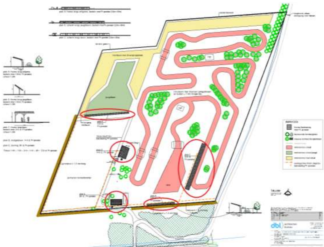
figuur 3: Afbeelding plan met rood omcirkeld de plaatsen met PV-panelen
