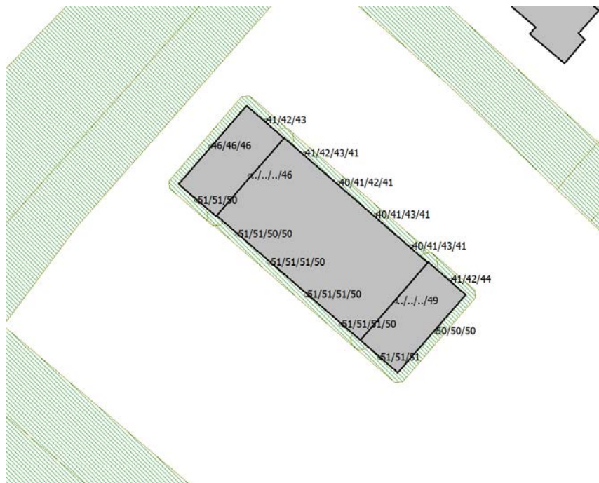
Figuur 4.4 Rekenresultaten blok A (N325 inclusief 2 dB correctie artikel 110g)
