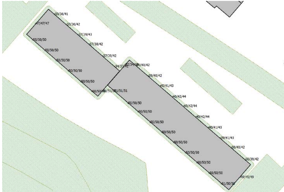
Figuur 4.5 Rekenresultaten blok B en C (N325 inclusief 2 dB correctie artikel 110g)
