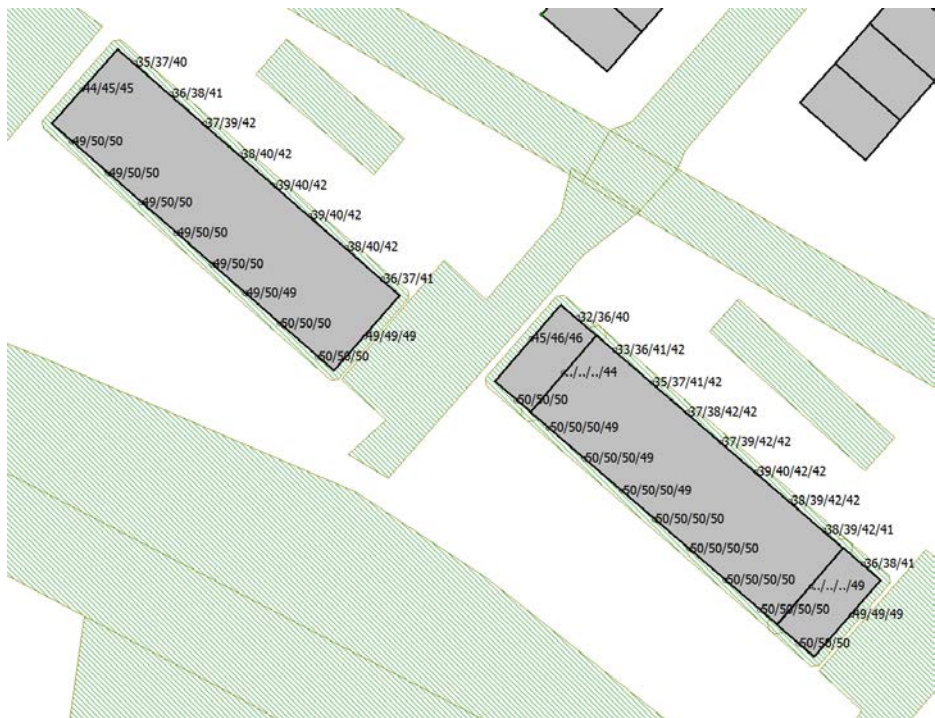
Figuur 4.6 Rekenresultaten blok D en E (N325 inclusief 2 dB correctie artikel 110g)
