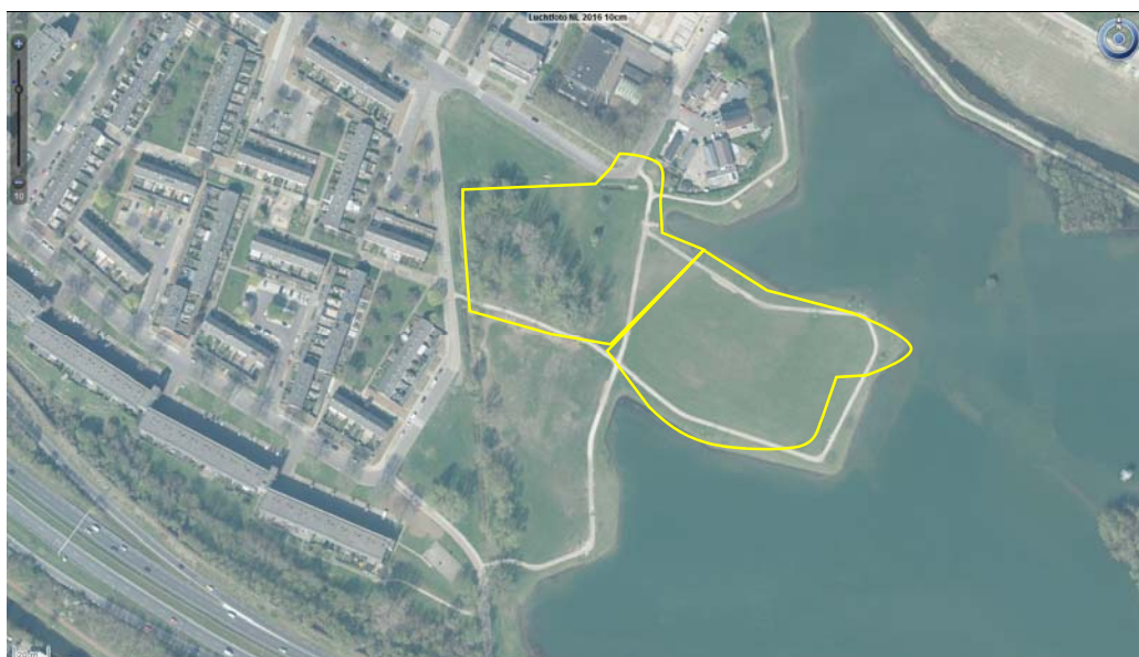
Figuur 2.1 Luchtfoto met ligging voormalige stort (in gele contour). Het oostelijke deel van de stort is reeds beschikt en voorzien van een leeflaag, de contour van het westelijke deel is aangegeven door de gemeente Arnhem (bron luchtfoto: Cyclomedia)
