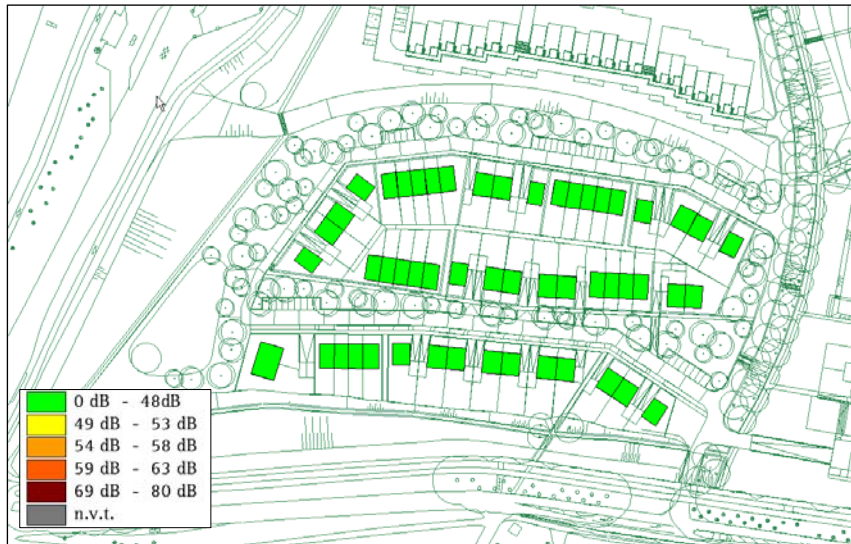
Figuur 4.8: Geluidsbelastingen ten gevolge van de Apeldoornseweg met een geluidswal van 3 m hoogte, een waarneemhoogte van 7,5 m (inclusief correctie conform artikel 110g)
