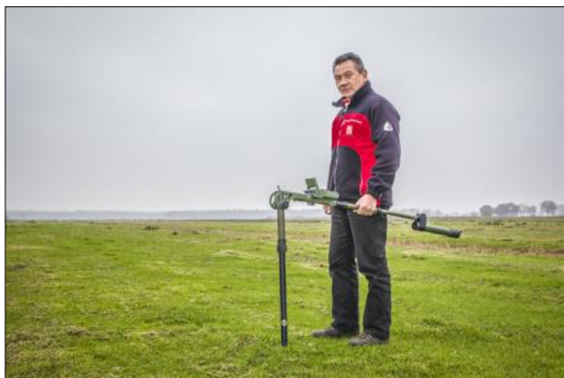
Figuur 3. Passieve realtime oppervlakedetectie met een Vallon VX1 Magnetometer en een staafdiagram waarop het maximale detectiebereik ( m^2 - maaiveld) per kaliber.
