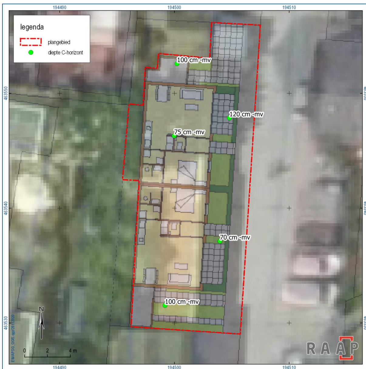
Figuur 16. Diepte van de onverstoorde ondergrond (hier in alle boringen de top van de C-horizont) geprojecteerd op het inrichtingsplan.
