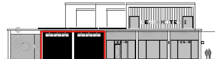
Figuur 5-4. De overzichtstekening van de oostgevel van de Coop en Dekamarkt. Roodomlijnd het metselwerk met stootvoegen en open spouwmuur. Bron: SUM Architecten, 2021.
