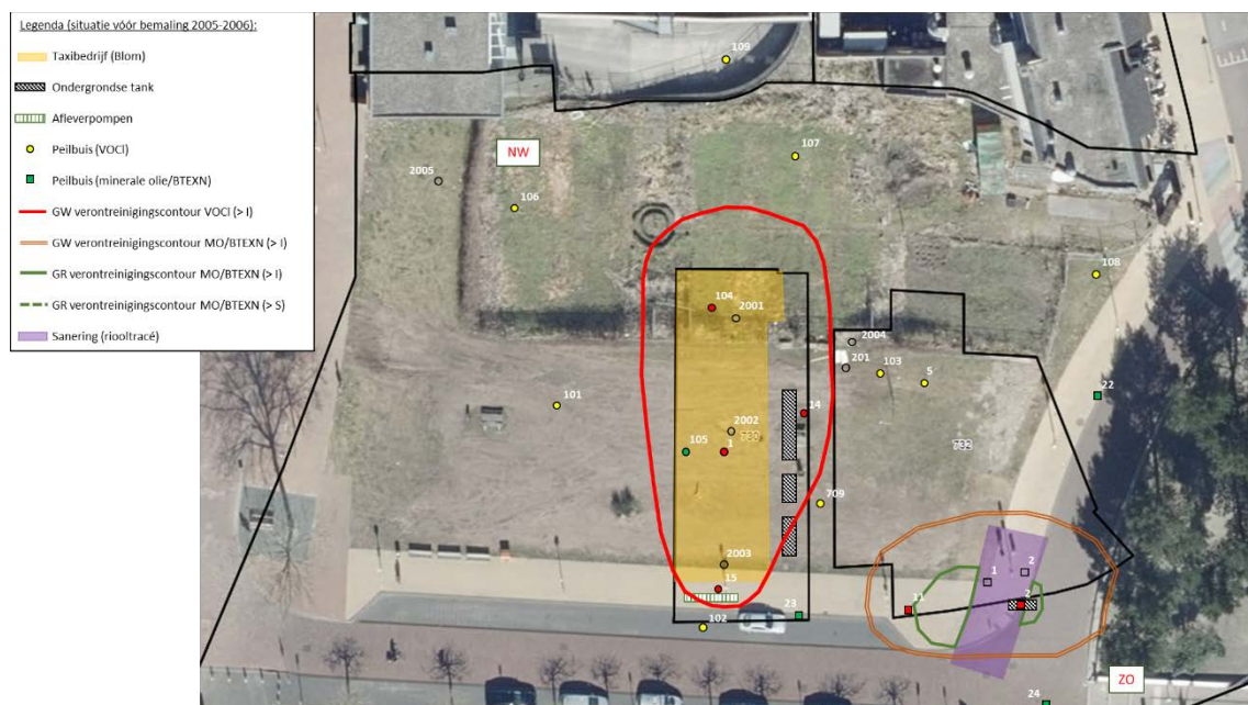
Figuur 2.1 Tekening voor bemalingswerkzaamheden (2005-2006) met daarop aangegeven de verontreinigingscontouren
